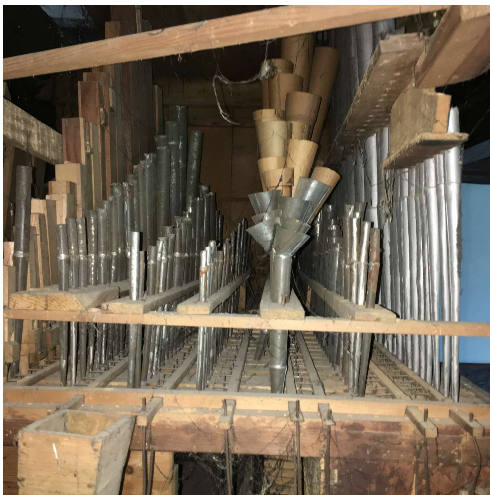
Vista laterale del somiere, con i crivelli e le canne
